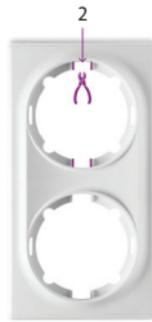
pour une installation en position verticale, retirez les bandes (2) à l'intérieur du cadre
