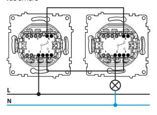
Schéma de câblage pour interrupteur double vaet-vient, simple allumage 1E3160130x-E
