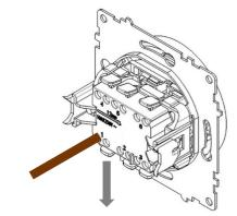
7. Insérez l'appareil (interrupteur à 1 ou 2 voies) avec les fils connectés dans la boîte de jonction avec précaution afin de ne pas endommager fils et ne pas perturber la fiabilité de leur connexion. Évitez les plis et les bourrages dans les fils. Les fils doivent reposer librement dans la boîte.
