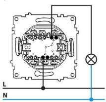
Schéma de structure de contrôle pour 2 emplacements utilisant des interrupteurs simple va-et-vient (nécessite 2 interrupteurs 1E3140130x-E)
