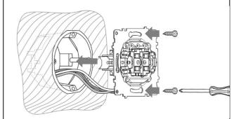
8. Lors de la fixation de l'appareil avec des griffes, serrez les vis sur les côtés à l'avant de l'appareil.
