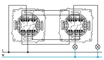
Schéma et emplacement des bornes interrupteurs croisé, vue arrière
