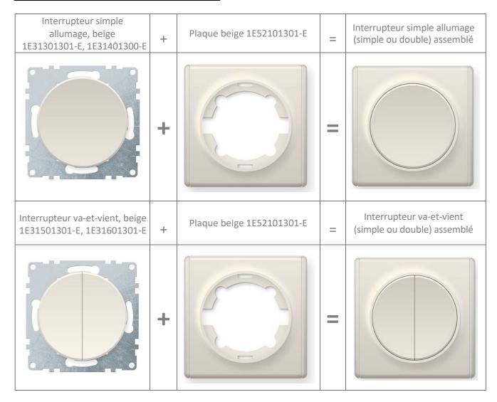
Le produit est conçu pour être installé dans des boîtes d'encastrement standard selon DIN 49073, avec une distance entre les vis de fixation de 60 mm et une profondeur minimale de 40 mm (non inclus dans l'emballage).
