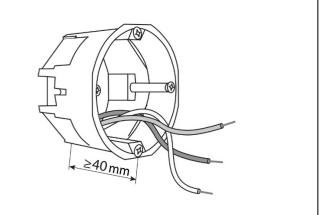
3. Assurez-vous qu'il n'y a pas de potentiel dangereux sur les fils L (N et PE) et qu'il n'y a pas de tension entre tous conducteurs à l'aide d'un indicateur de tension.
